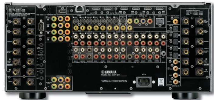
Ein AV-Verstärker wie der Yamaha DSP-Z11 muss HDMI-Signale nicht nur durchleiten, sondern auch entschlüsseln und wieder neu codieren.
